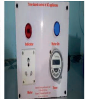
Timer controller for fountain aerator मण्डल मत्स्य ह्याचरी तिलोत्तमा-14, टिकुलिगण, रुपन्देही
