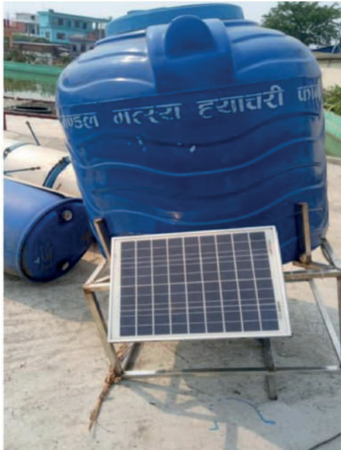
Solar based automatic fish feeder लक्ष्मी मत्स्य फार्म सियारी-०५, सिद्धपुर, रुपन्देही
